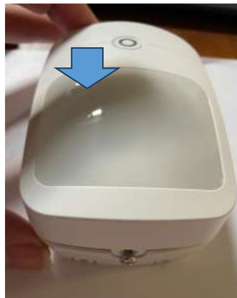
Una volta allentata la vite e sollevato leggermente il sensore dalla basetta, spingere dall'alto verso il basso per disaccoppiarlo
